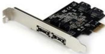
La Tarjeta Controladora PCI Express SATA III (6 Gbps), PEXESAT322I ofrece la opción de incorporar 2 puertos SATA internos o externos a su ordenador, a través de una sola ranura PCI Express (x1). La tarjeta dispone de una selección de jumpers integrados, por lo que se puede configurar para agregar 2 puertos SATA III internos o externos, o uno de cada uno, según sea necesario.
