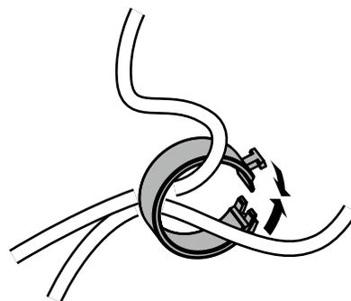
3. Halten Sie die Kabelhalterung geschlossen, und führen Sie sie in den Fuß ein.
