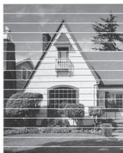
Una vez que el inyector del cabezal de impresión esté limpio, desaparecerán las líneas horizontales.
