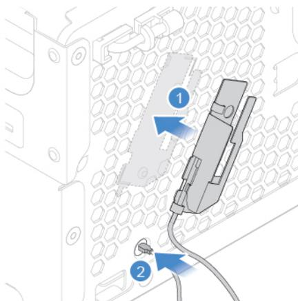
Figura 41. Instalación de la antena Wi-Fi frontal
