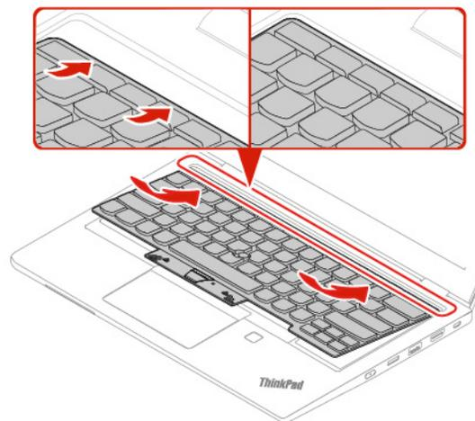
11. Deslice el teclado en la dirección que se muestra. Asegúrese de que los seguros bajo el marco del teclado se encuentra colocados.
