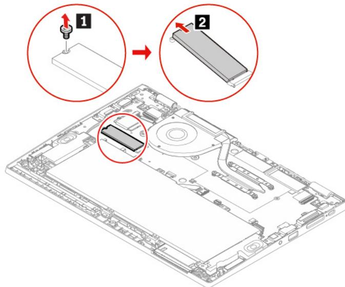
7. Inserte la nueva unidad de estado sólido M.2 en la ranura de la unidad **1**. A continuación, gire la unidad hacia abajo e instale el tornillo para fijar la unidad **2**.
