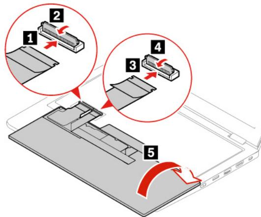
10. Inserte el teclado en el bisel del teclado, como se muestra. Asegúrese de que el borde superior del teclado (el borde que está cerca de la pantalla) se encuentre bajo el bisel del teclado.
