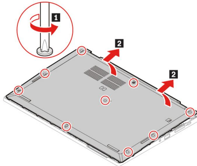
5. Instale el nuevo conjunto de la cubierta de la base en su lugar **1**. Asegúrese de que los pestillos del conjunto de la cubierta de la base están bien fijados bajo el conjunto de la cubierta de la base **2**. A continuación, apriete los tornillos para fijar el conjunto de cubierta de la base **3**.
