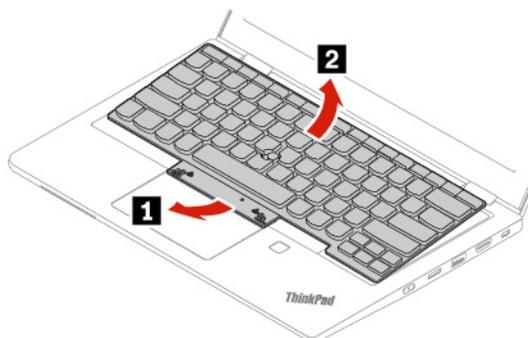
8. Coloque el teclado en el reposa manos como se indica y desconecte los conectores. A continuación, extraiga el teclado.
