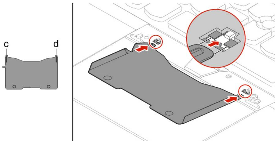
6. Gire la herramienta en la dirección que se muestra para liberar el teclado **1**. Empuje el teclado en la dirección que se muestran las flechas **2** para liberar los seguros del bisel del teclado.
